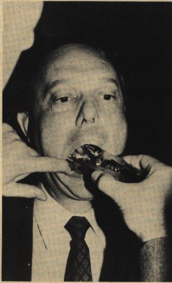
Voici le capteur de forme avec fibres optiques. Sa fonction est de capter puis de coder en trois dimensions la forme d'une ou plusieurs dents, d'un articulé ou d'une face. D'une simple photographie, les protagonistes codent la forme en x, y, z, à quelques dizaines de microns près. C'est la pièce maîtresse de l'ensemble. Elle supprime toutes les prises d'empreinte et assure une saisie de la forme dentaire à la fois rapide (1 ou 2 secondes) et précise (moins de 20 microns). Elle évite tous les travaux de laboratoire y compris les mises en articulateurs.
