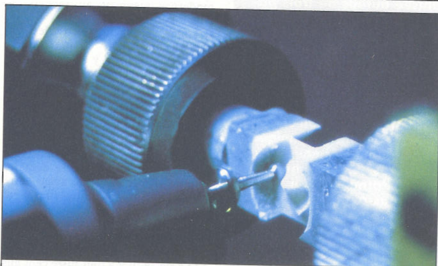
La fraise à commande digitale exécute l'intérieur et l'extérieur de la couronne.
