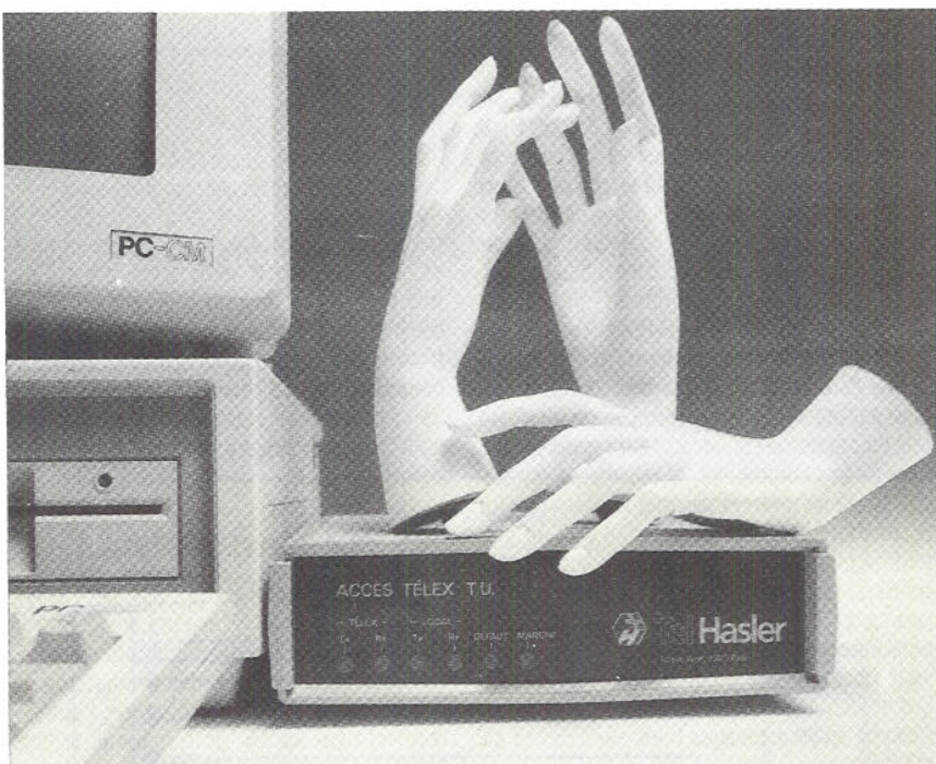
Ce boîtier transforme un micro-ordinateur en terminal télex.
