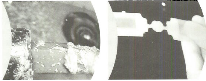
図32 内面の加工が終了してブロック を回転させて外面を削る。奥の穴から 工具がつぎつぎにでてくる。 図33 外面の加工も終了して、保持部 だけが残った状態。手作業で切り落 し、修整研磨して完成する。
