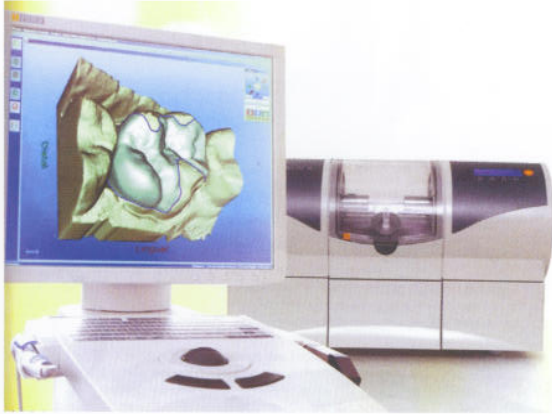
Figure 20 : unité de travail et d'élaboration CFAO Cerec® de Sirona en cabinet (2008).
