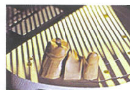
Figures 6 et 7 : scannage des volumes dentaires, optiquement ou par palpage .
