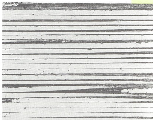
Fig. 5: Coupe polie du tenon examinée à la binoculaire. On peut observer la disposition longitudinale des fibres ( \delta\mu ).
