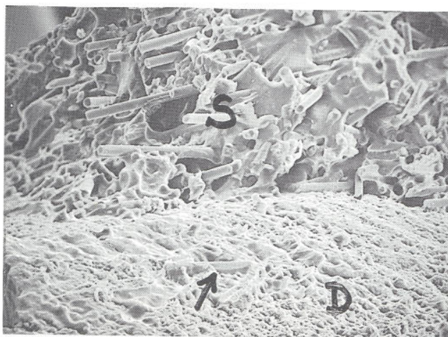
Fig. 11a et b : Fractographies dentine / SiliPost examinées au MEB a-133X et b-402X. Il faut remarquer la fracture cohésive qui atteste de la parfaite adhérence entre les deux surfaces : la flèche F indique des parties de SiliPost S qui sont restées fixées sur la dentine D. On peut également observer la disposition aléatoire des fibres de verre courtes du SiliPost (200 \mu ).
