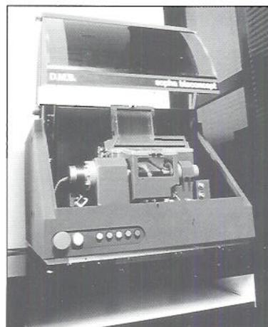
Fig. 4 Troisième module DMS pour l'usinage automatique des prothèses.
