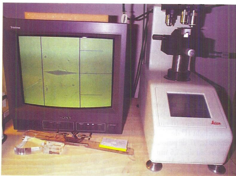
Photo n° 3: Microduromètre Leica et photo d'impact sur un échantillon de composite
