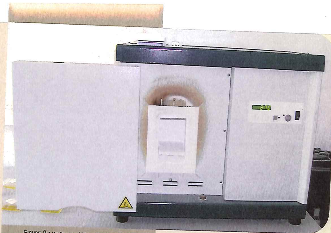
FIGURE 9 : Un four de frittage ou Lava® therm.
