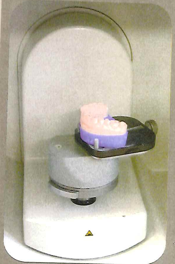
FIGURE 4 : Scanner optique et modèle prêt au scan- nage.
