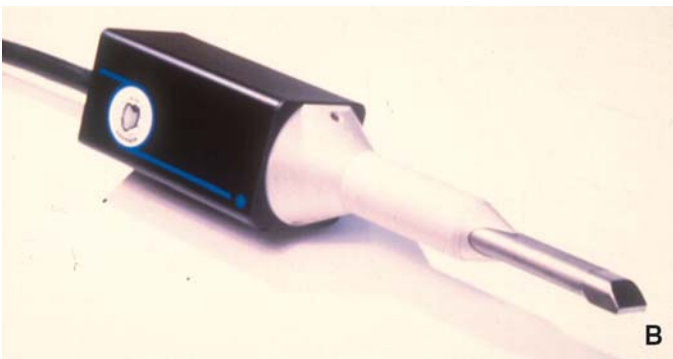
Figure 14. Caméra Hennson-Duret (profilométrie à projection conique).
