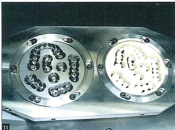
Fig. 11 - La machine Etkon permet d'usiner différents matériaux et toutes sortes de prothèses fixées, en zircono ou en titane.
