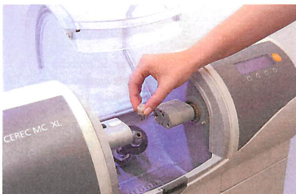
3. La MOCN (machine-outil à commande numérique) au sein du cabinet dentaire.
