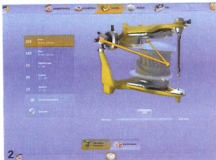
2. Articulateur virtuel du logiciel Cerec 4.2 pour la mise en relation, juste après l'acquisition, des arcades digitalisées (photo Sirona).
